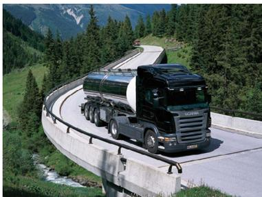
**La combinación de una curva y una frenada cuando se conduce una cisterna con líquidos ocasiona el desplazamiento de la carga...**
